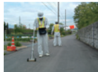
FIDガス検知器による漏洩検査
