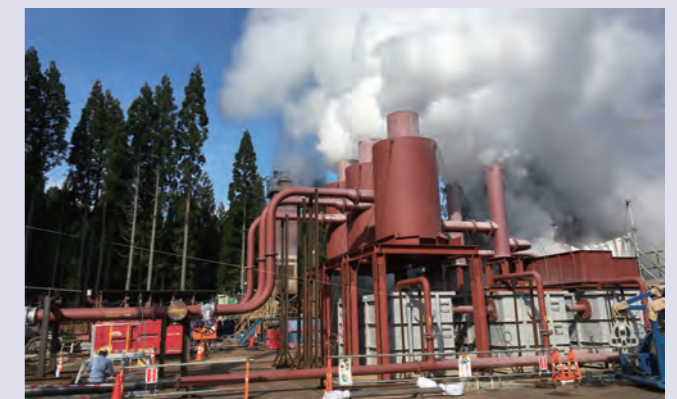
秋田県湯沢市小安地域での地熱調査井仮噴気試験の様相(2017年11月)
