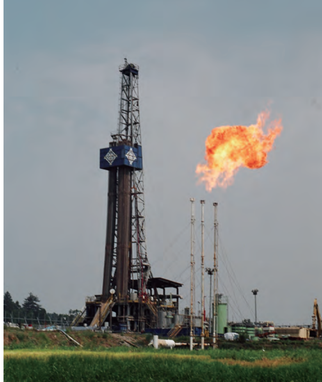
南長岡ガス田における試ガス
